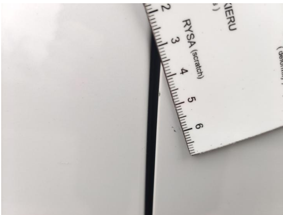
Fot. 48. Drzwi tylne P - Rysa/odprysk 1
