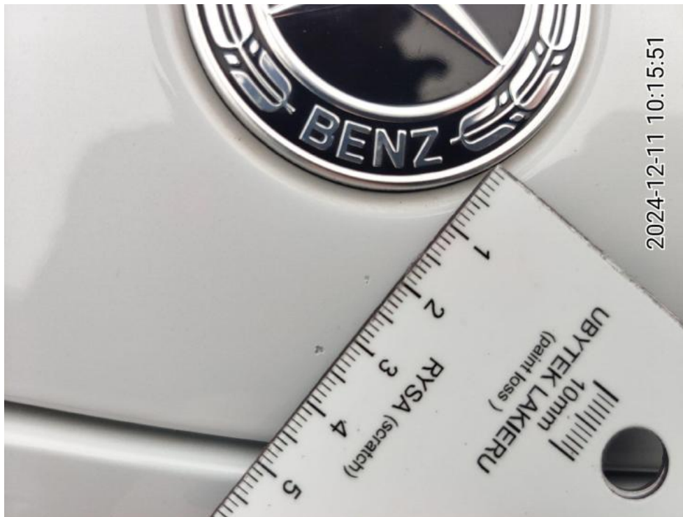
Fot. 41. Pokrywa komory silnika - Rysa/odprysk 1
