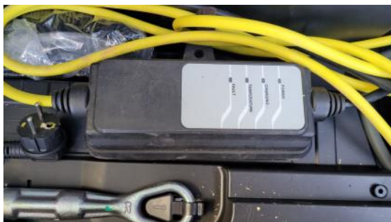
Fot. 29 Stacja ładowania baterii trakcyjnej
