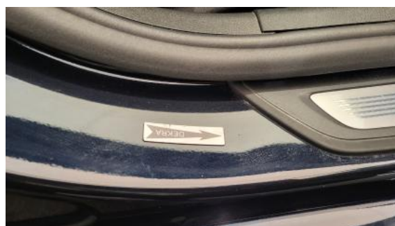
Fot. 32 Próg P - Wgniecenie/odkształcenie 1
