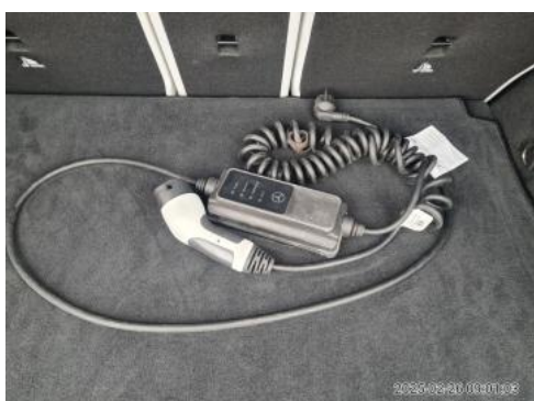
Fot. 31 Przewód ładowania baterii trakcyjnej
