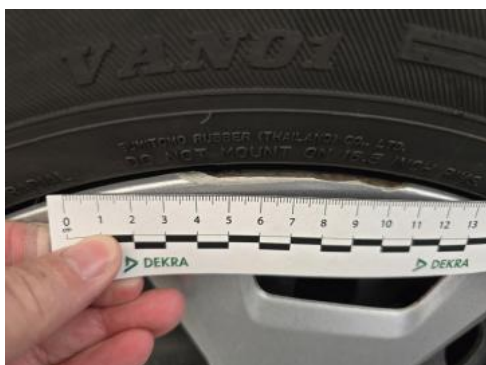
Fot. 39 Kołpak przedni P - Pęknięcie/rozerwanie 1
