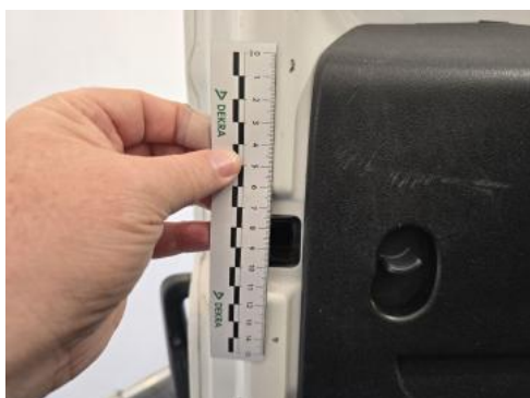
Fot. 51 Drzwi tyłu lewe - Rysa/odprysk 2
