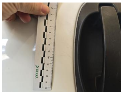
Fot. 46 Drzwi przed L - Rysa/odprysk 1
