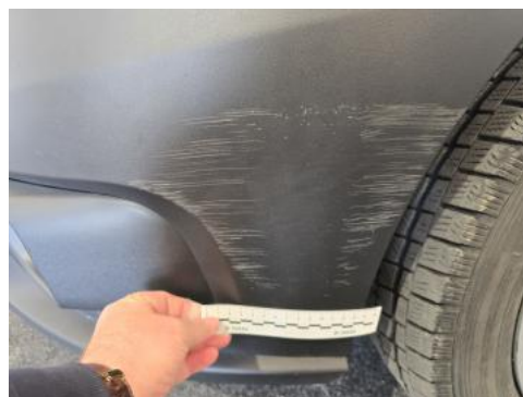
Fot. 38 Zderzak - Rysa/odprysk 1
