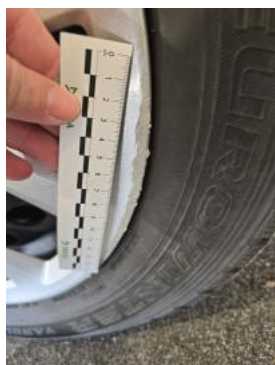
Fot. 49 Kołpak przedni L() - Rysa/odprysk 3
