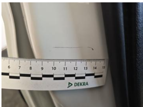
Fot. 41 Słupek środkowy P - Rysa/odprysk 1
