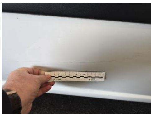
Fot. 45 Błotnik tylny L / Ściana boczna L() - Rysa/odprysk 3
