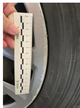
Fot. 48 Kołpak przedni L - Rysa/odprysk 1
