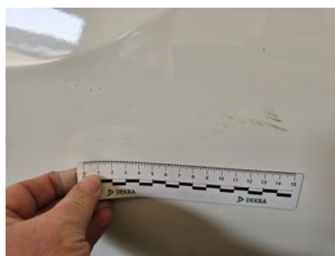
Fot. 44 Błotnik tylny L / Ściana boczna L - Rysa/odprysk 1
