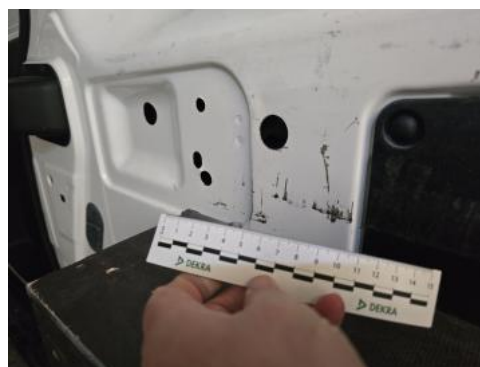
Fot. 56 Ściana prawa - Rysa/odprysk 1
