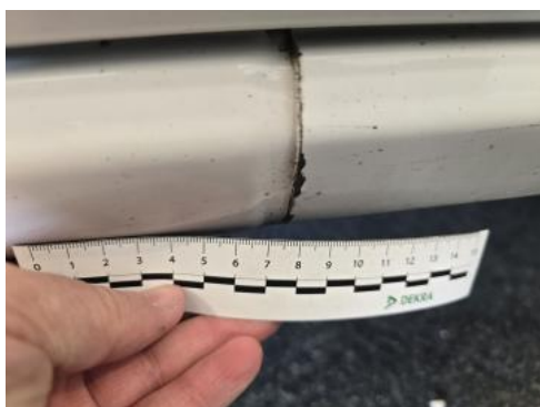
Fot. 47 Próg L - Rysa/odprysk 1
