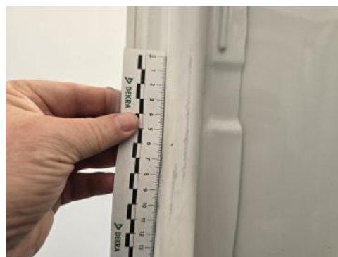
Fot. 52 Drzwi tyłu lewe() - Rysa/odprysk 3
