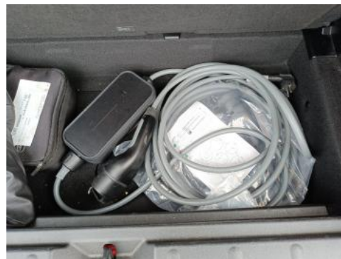
Fot. 26 Przewód ładowania baterii trakcyjnej
