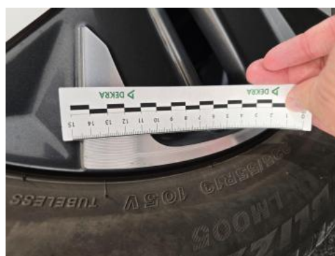
Fot. 48 Felga aluminiowa tylna P - Rysa/odprysk 1
