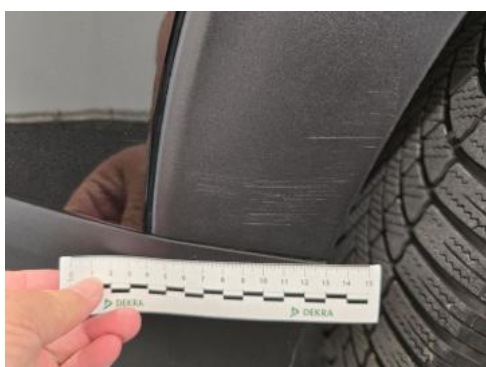
Fot. 47 Błotnik tylny P / Ściana boczna P - Rysa/odprysk 1
