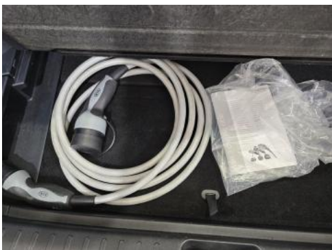
Fot. 27 Przewód ładowania baterii trakcyjnej
