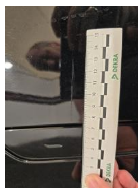
Fot. 44 Drzwi przednie P - Rysa/odprysk 1
