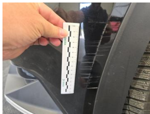
Fot. 42 Zderzak - Rysa/odprysk 1
